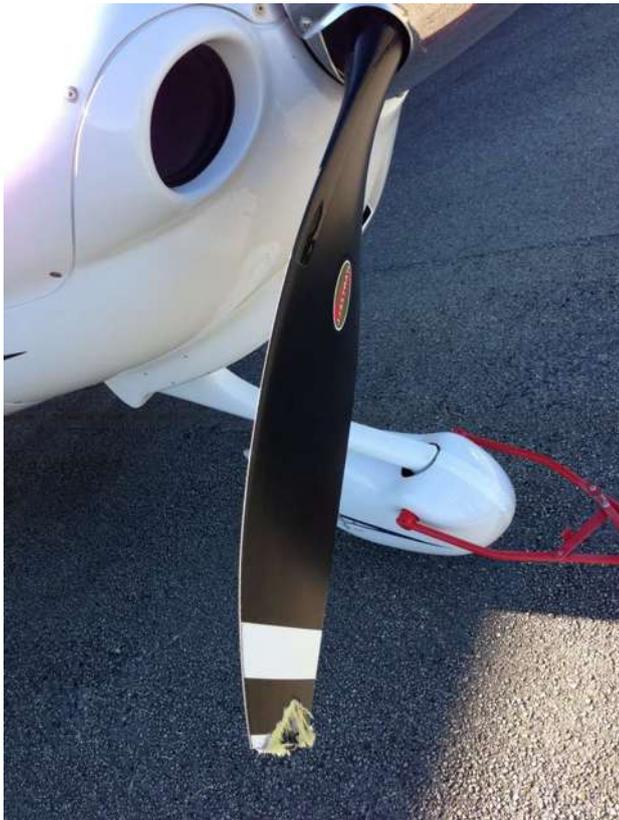
Tout d'abord, si la barre de tractage vient en rentrer en collision avec l'hélice moteur tournant des morceaux de métal pourraient être projetés et provoquer des dommages matériels mais aussi physique à des tiers.
