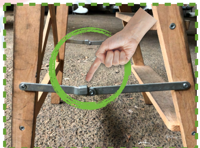
Position des compas verrouillés
